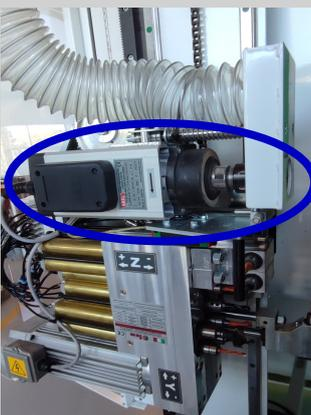
**Fresador de alta frecuencia 18.000rpm**
