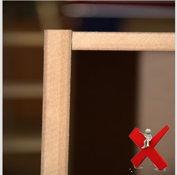
**B.—** Fallos provocados por falta de corrección en largo y/o descuadre de la pieza (máquinas sin palpador electrónico)
