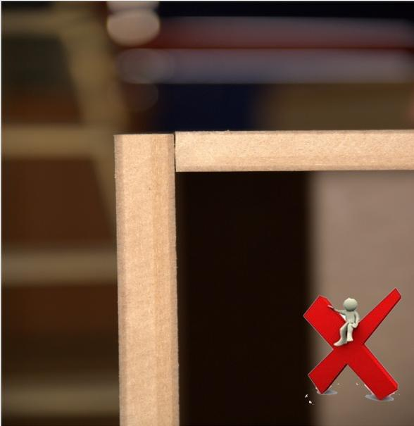
**A.—** Fallos provocados por diferencia de espesor del material en máquinas con el taladro del lado inferior o posterior.
